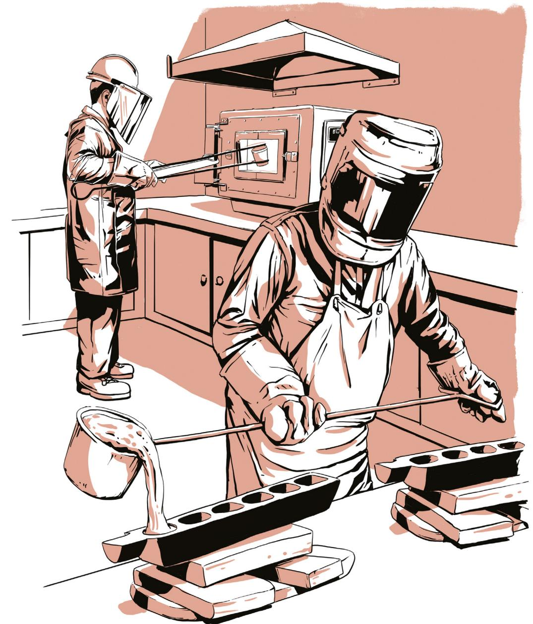
*Se buscó reducir el tiempo de exposición al calor de los trabajadores durante el carguío de régulos, al introducir las partes más puras de los metales en copelas precalentadas en la mufla.*
